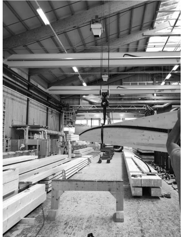
Vorgespannter Biegeholzträger (Bild: ETH Zürich)
